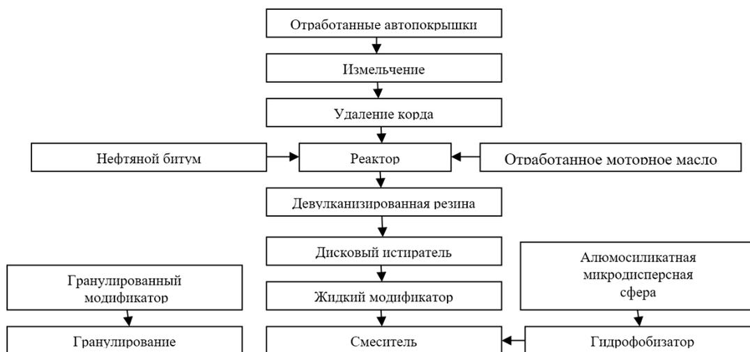
**Рис. 1. Технологическая схема получения модификатора**
