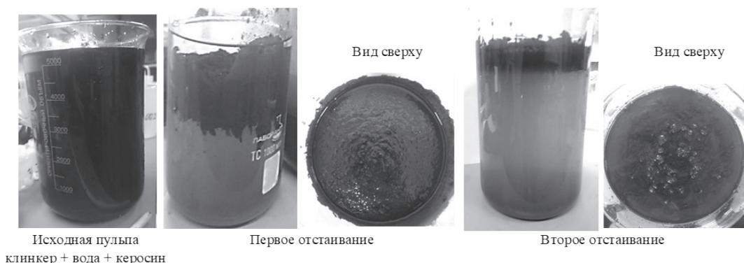
Рис. 2. Выделение углерода экстракцией
