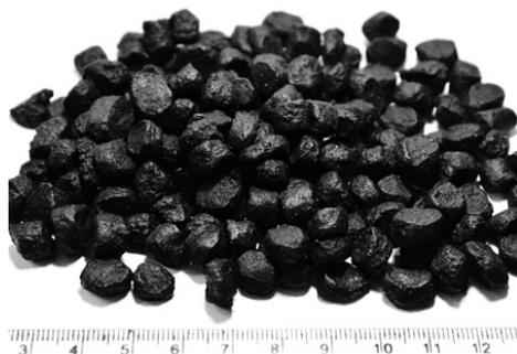
**Рис. 2. Гранулированный модификатор битума МД01**
