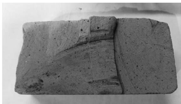
Рис. 1. Реакция окрашивания фенолфталеина на карбонизированном образце кирпича из лежалого шлака РФХ
