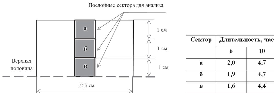
Рис. 2. Модель разреза с указанием секторов, отобранных для анализа карбонизированного кирпича, с результатами содержания углерода (% масс.) по слоям
