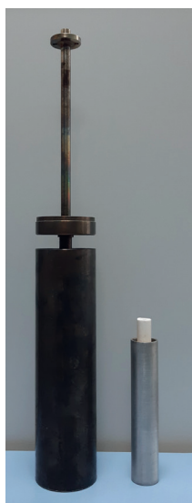
Рис. 2. Общий вид двух ампул реперных точек: классическая (слева), малогабаритная конструкции ВНИИМС (справа)
