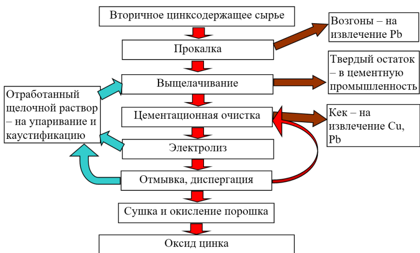
Рис. 1. Схема получения оксида цинка из электролизного цинкового порошка
