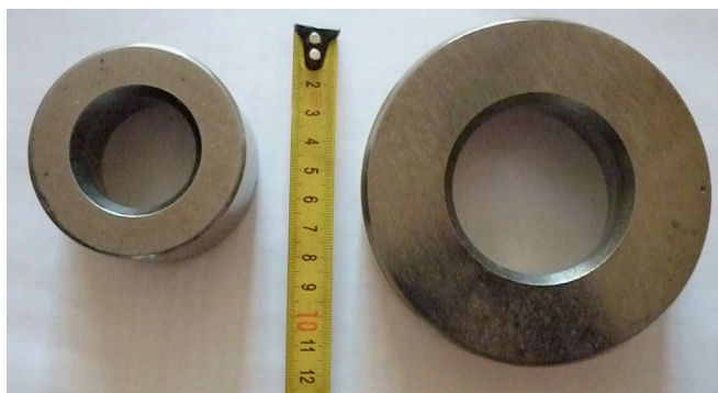
Рис. 2. Заготовки волок, полученные СВС-процессом и компактированием из композиционного материала системы Ti-Cu-C после обдирки, электроэрозионной обработки и шлифования
