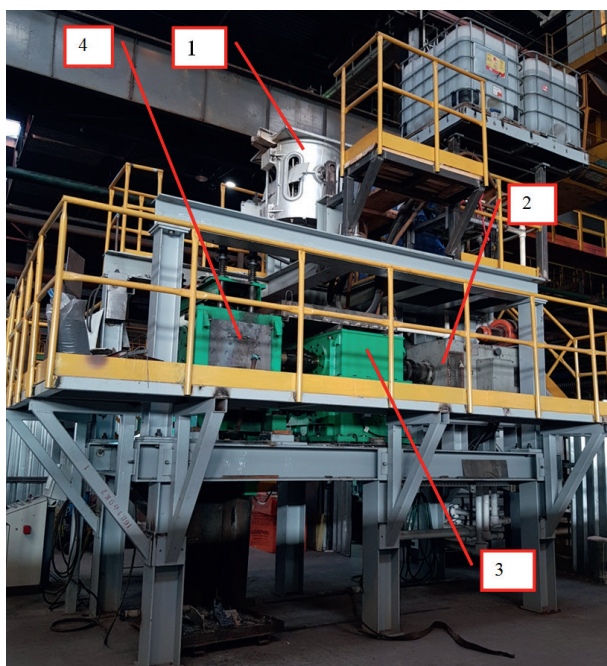
Рис. 1. Участок непрерывного литья и деформации ОАО «Уральский трубный завод»: 1 – индукционная печь; 2 – электродвигатель постоянного тока; 3 – редуктор-синхронизатор; 4 – станина установки
