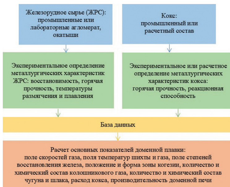
Рис. 3. Блок-схема определения влияния металлургических характеристик железорудного сырья и кокса на показатели доменной плавки
