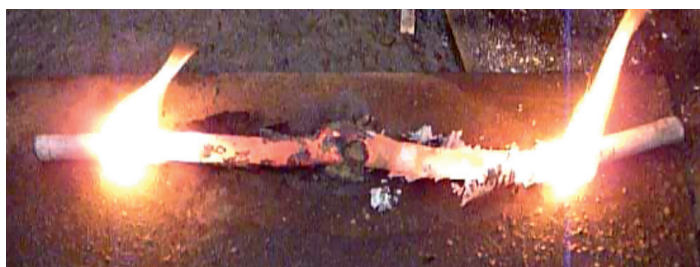
Рис. 1. Горение двух образцов СВС-шихты системы Ti-Cu-C
