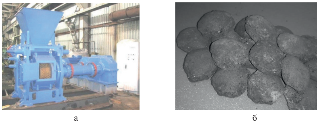
Рис. 4. Валковый брикетировочный пресс ПБВ-600/250–100 (а) и брикеты из карбида кремния, полученные на нем (б)
