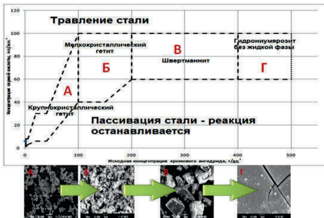
Рис. 2. Диаграмма кристаллической структуры осадков в системе «хромовый ангидрид — серная кислота — стальная стружка» при различных концентрациях и постоянном количестве стружки ( 2,25 \text{ м}^2/\text{дм}^3 ), \times 3000
