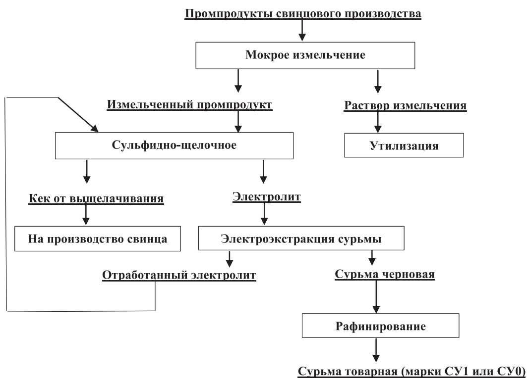
Рис. Принципиальная технологическая схема переработки промпродуктов свинцового производства гидromеталлургическим способом
