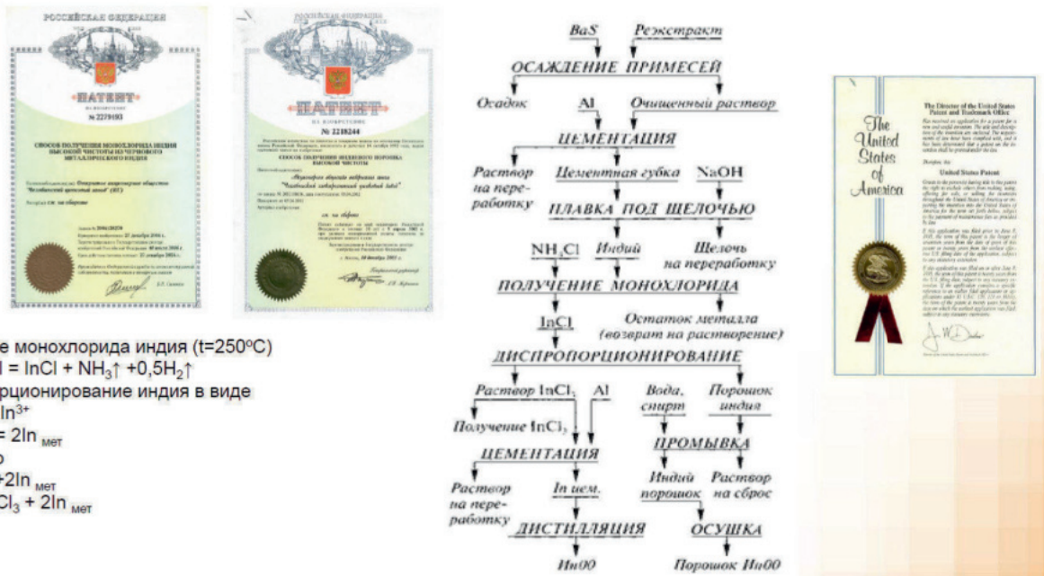
Рис. 4. Технологическая схема получения порошка индия высокой чистоты
