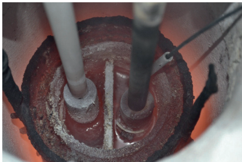
Рис. 1. Двухсекционная электролизная ячейка для переработки отработанных катализаторов: слева — секция электролиза с графитовым анодом, справа — секция рафинирования с графитовым катодом, покрытым слоем TiB_2 , с алундовым накопителем алюминия и термопарой в алундовом чехле
