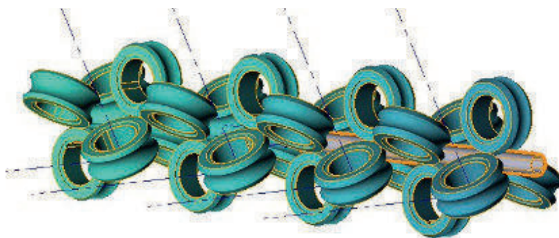
Рис. 3. Расположение валков редуционного стана при постановке задачи
