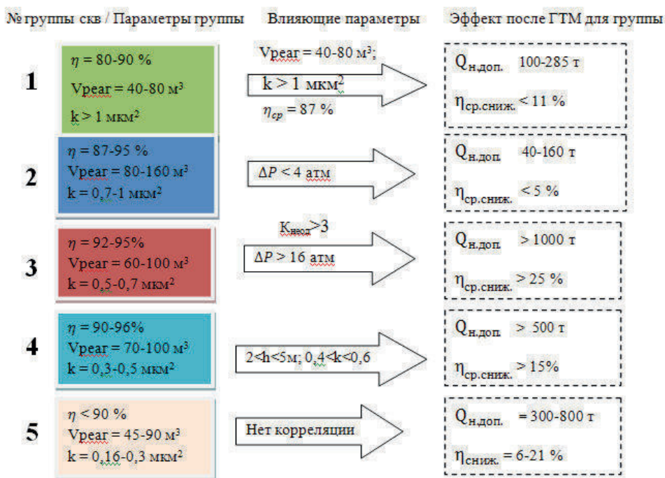
Рис. 6. Алгоритм выбора скважин-кандидатов по технологии ограничения водопритоков для условий объекта № 1
