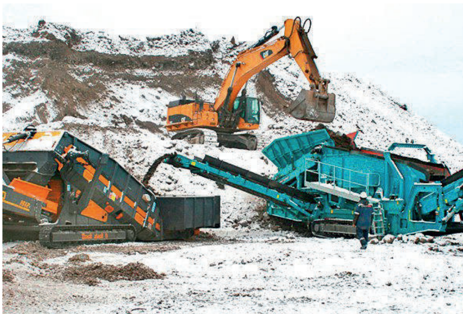
Рис. 3. Дробильно-сортировочный комплекс по переработке отвальных шлаков Белорещкого металлургического завода
