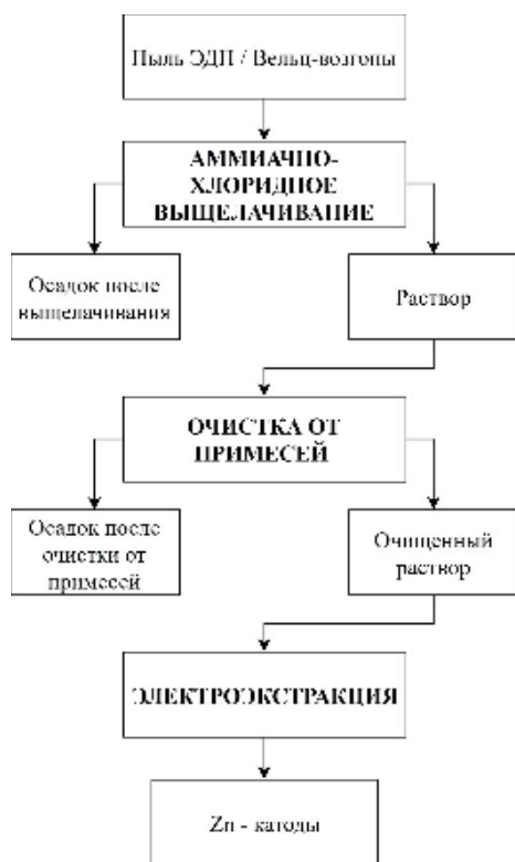
Рис. 1. Принципиальная технологическая схема EZINEX-процесса
