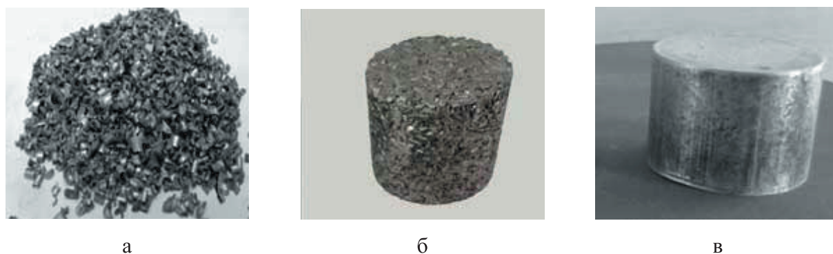
Рис. 2. Внешний вид стружки сплава АК12 (а), холоднбрикетированной (б) и горячепрессованной (в) заготовок-брикетов
