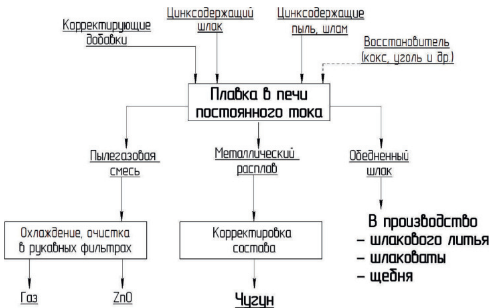
Рис. 4. Принципиальная схема переработки цинксодержащих техногенных отходов
