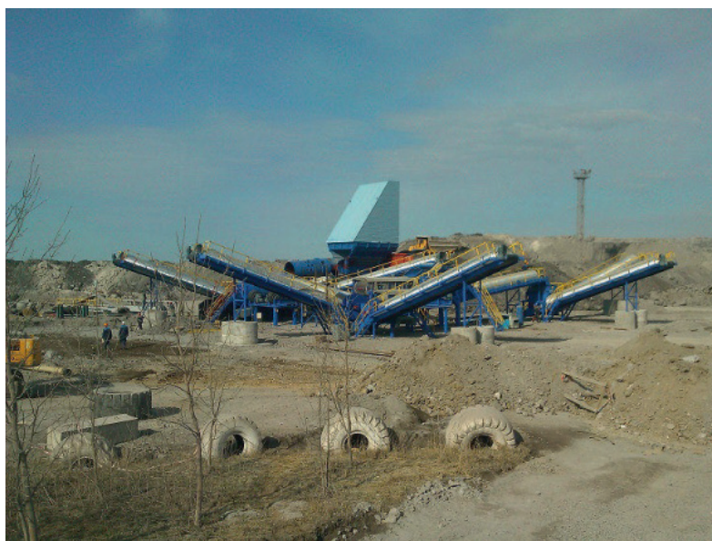
Рис. 2. Вид дробильно-сортировочной установки по переработке металлургических шлаков на комбинате «Северсталь»
