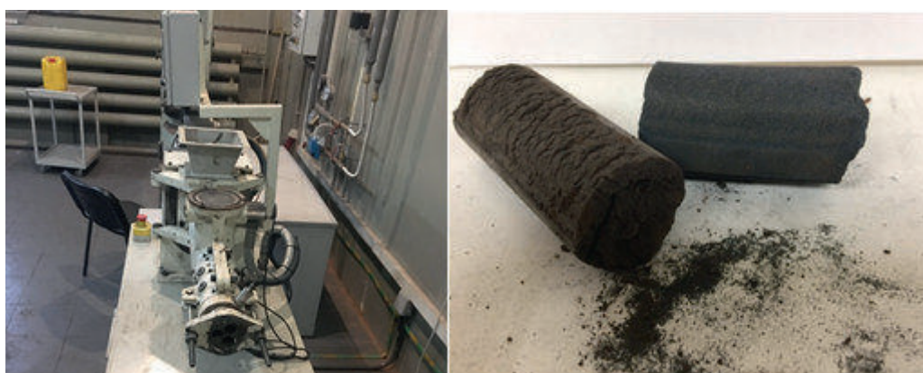
Рис. 5. Лабораторный вакуумный экструдер в ЦИС и сформированные брикеты
