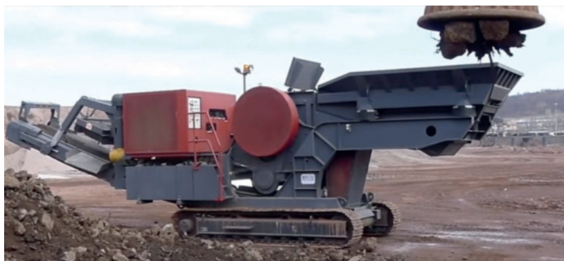
Рис. 6. Установка для очистки зашлакованного скрапа
