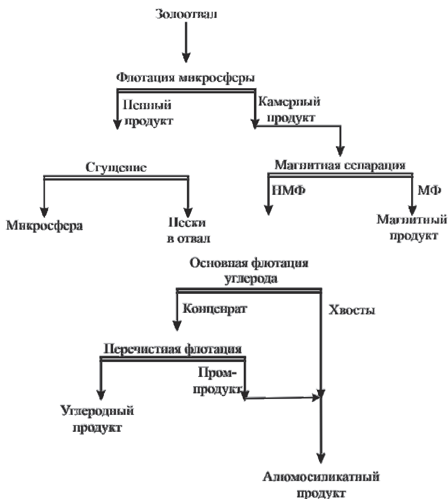
Рис. Основные операции схемы комплексной технологии обогащения золы, разработанной в ОИВТ РАН: НМФ — немагнитная фракция; МФ — магнитная фракция
