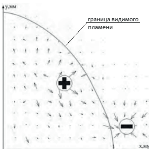
Рис. 2. Схема расположения ионов различной полярности в пламени
